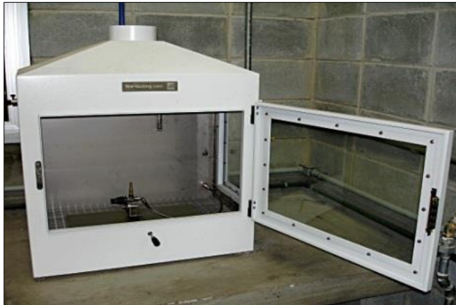
Figura 34: Determinação da ignitabilidade dos materiais.
