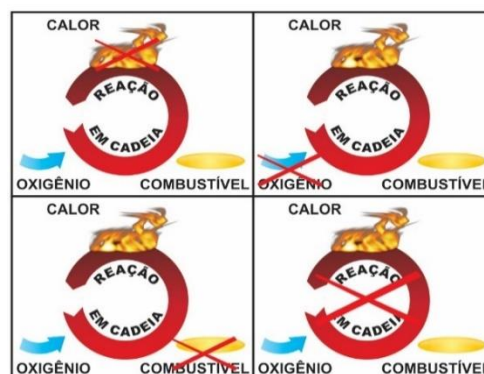
Figura 16: Formas de extinção do fogo
