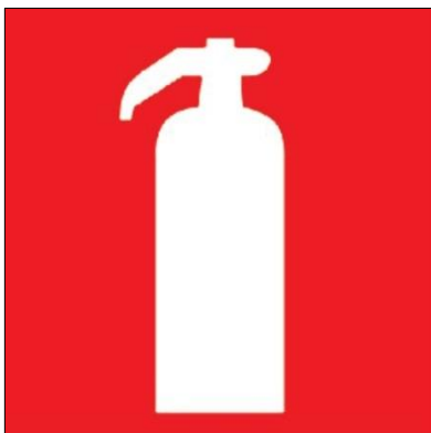
Figura 51: Sinalização de extintores de incêndio.
