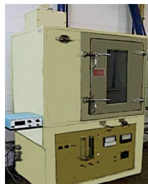
Figura 31: Câmara de densidade óptica fechada.
